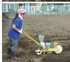
自動播種機を運転して4列ずつ播いていく。機械が方向転換する畑の端の部分は手動の種まき器で補う
