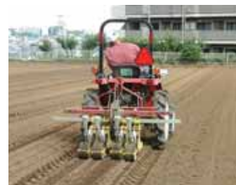
自動播種機を運転して4列ずつ播いていく。機械が方向転換する畑の端の部分は手動の種まき器で補う
