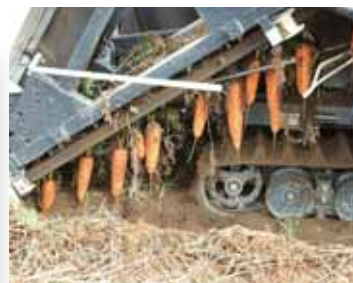
掘り取り機を運転する高橋さん。連続して抜かれるニンジンが、葉と細い先端部分をカットした状態でコンテナに落とし込まれる
